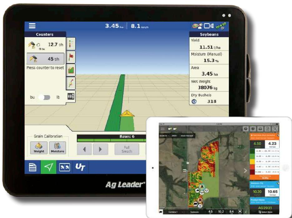
Quando arriva il momento della raccolta, InCommand collega con AgFiniti l'intera operazione attraverso i monitor, i dispositivi e le macchine. Controlla in diretta le operazioni in campo, incluse mappe e statistiche che mostrano resa e umidità. Conosci la posizione di ogni macchina e quando è il momento di scaricare.
