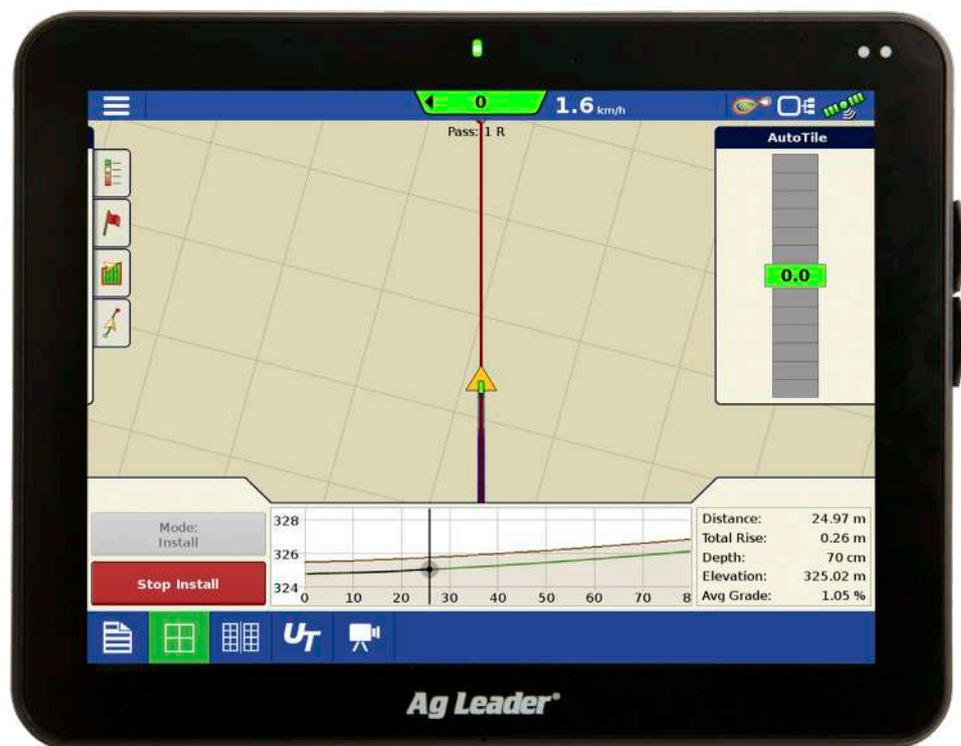
**InCommand con Intellislope assicura controllo e precisione per la posa di dreni in pendenza, senza complesse apparecchiature laser.**
