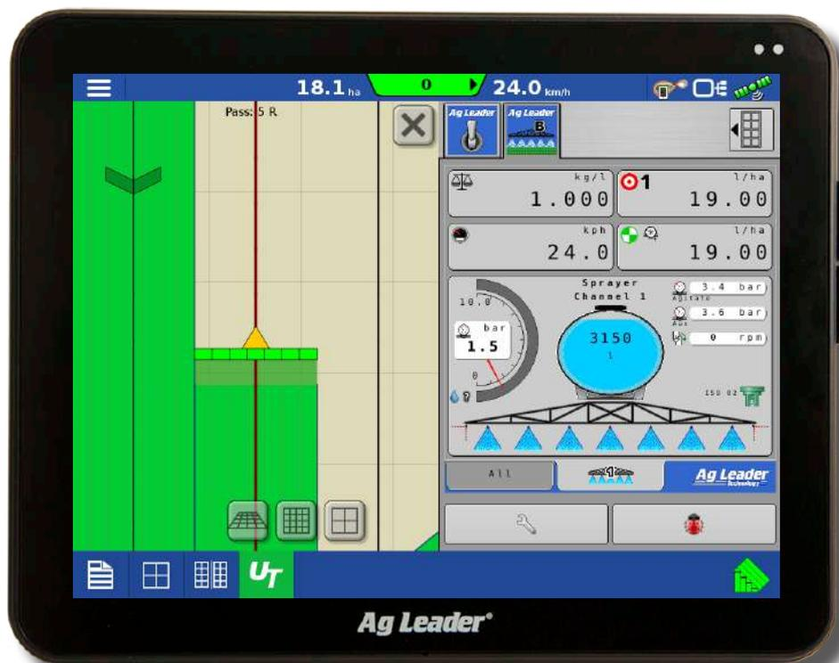
InCommand fornisce un controllo efficace dell'applicazione del prodotto, compresi il controllo della sezione, il rateo variabile e il monitoraggio specifico della dimensione delle gocce. Viene subito fornita la documentazione di quando e dove sono stati applicati i prodotti, così da tenere facilmente traccia delle operazioni effettuate.
