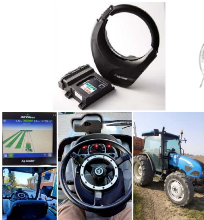
Figura 4 - Dispositivo installato per guida automatica.
