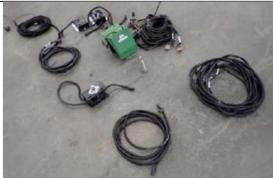
Figura 6 - Sistema di pesatura da installare sul veicolo.
