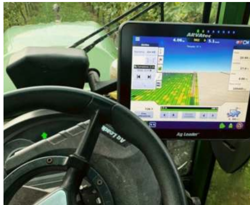
Figura 3 - Esempio di schermata per la visualizzazione in tempo reale del percorso.
