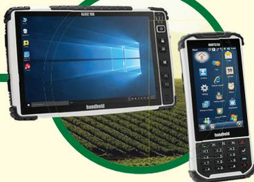
ARVAplant Mobile può essere configurato, in base alle esigenze, con due sistemi portatili differenti. Il palmare Nautiz X8 è orientato alla portabilità e compattezza mentre la soluzione Tablet Algiz X10 è specifico per eseguire progettazioni direttamente in campo e per avere una visuale sempre molto chiara.
