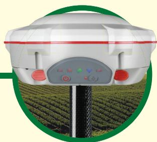
ARVAplant Mobile sfrutta il potente ricevitore GNSS T300. Versatile e con frequenza di aggiornamento fino a 20 Hz riceve le costellazioni GPS, GLONASS, GALILEO e BEIDOU consentendo di lavorare anche in zone difficili.
