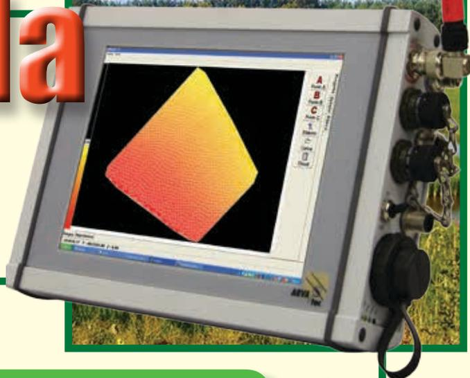
**GPS centimetrico per il rilievo di piani quotati e il controllo automatico della livella**
