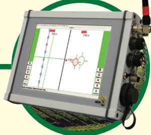
Computer di bordo touchscreen 8,4" con sistema GPS rover RTK. Questa soluzione riduce al minimo i cablaggi e rende più agevole lo spostamento su più trattori.
