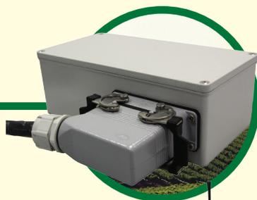
Centralina rugged con inclinometri a doppio asse e controllo scostamento trasversale macchina operatrice, radio modem, antenna GPS, kit posa senza filo (Optional). La centralina ha dimensioni molto contenute (25x15x10 cm).
