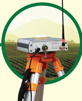
Stazione base GPS RTK con radio modem integrato e treppiede
