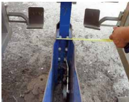
Foto 2 Particolare dell'assolcatore a doppio vomere della trapiantatrice Fornasier. Garantisce una elevata qualità di lavoro anche alle profondità di trapianto delle marze di nocciuolo
