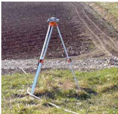
Foto 1 Stazione GPS base installata a bordo campo
